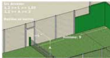
Figura 13. Medidas de los accesos para el caso de un solo acceso por lateral
