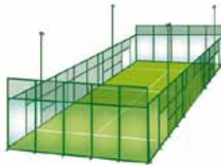
Figura 10. Cerramientos de vidrio de una pista de pádel
